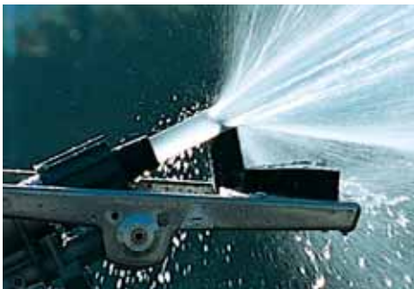
Dynamic intermittent jet-breaker in operation Dynamischer Intervall-Strahlstörer in Funktion
